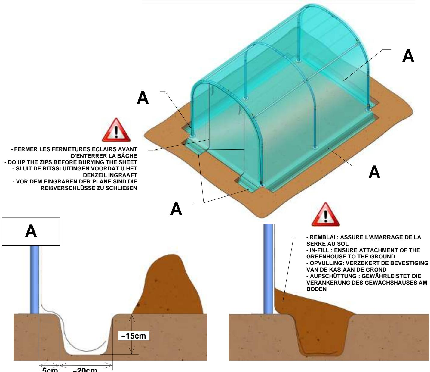
Le film doit être parfaitement tendu à la pose et le demeurer, par des vérifications complémentaires régulières, quelles que soient les conditions climatiques extérieures.
